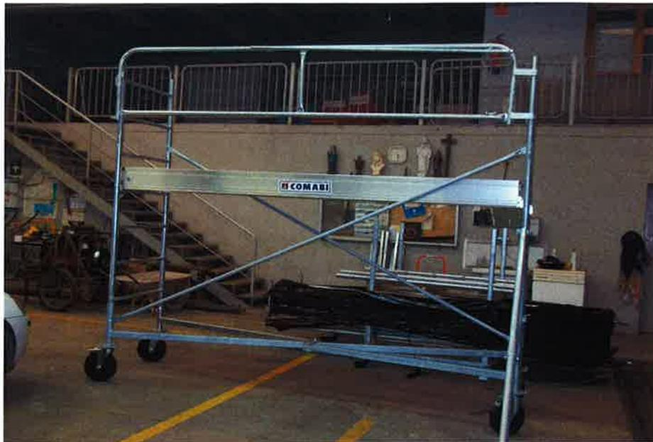
Plataforma ligera desmontable con ruedas blocantes y estabilizadores.
