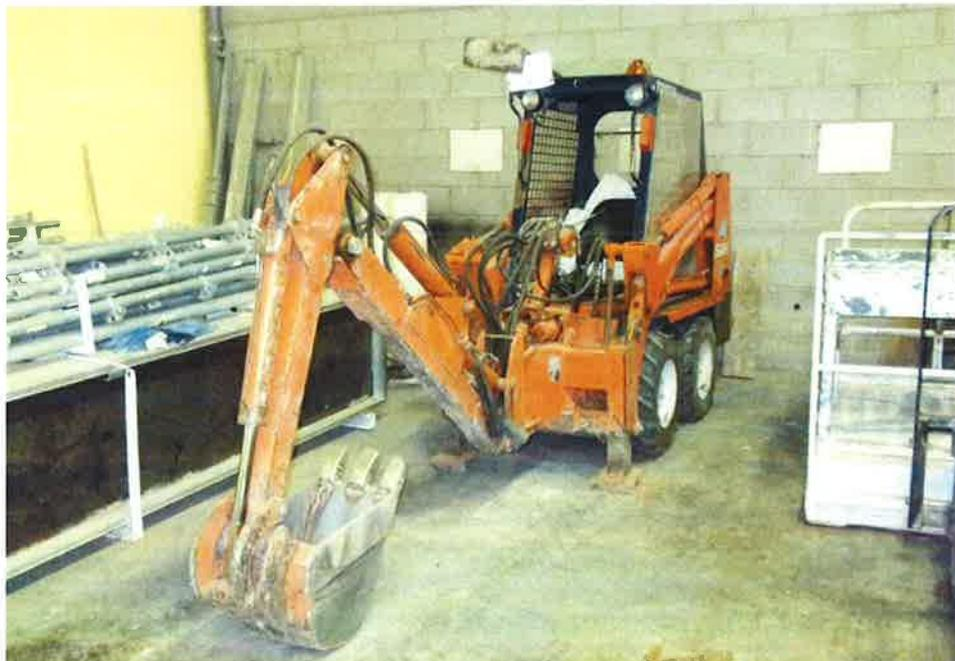
Mini retroexcavadora autopropulsada sobre ruedas.
