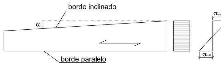
**Figura 6.9** Viga a un agua (Se llama borde paralelo a la cara que marca la dirección del laminado, e inclinado al opuesto, bajo la consideración de que se mantiene el sistema de laminación. Existen otras formas de laminación, pero no se contemplan en este Documento Básico)
