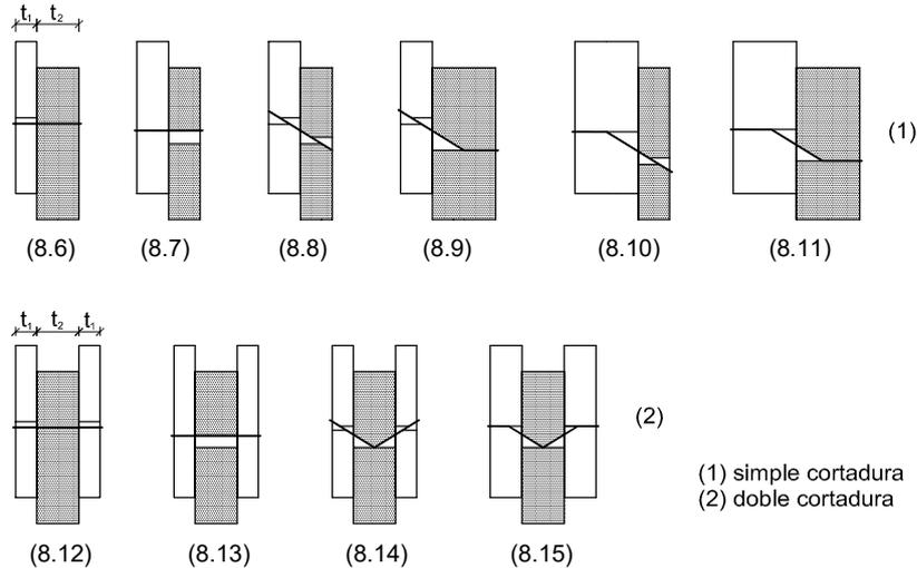
Figura 8.2 Modos de fallo en uniones de madera con madera y de madera con tablero.
