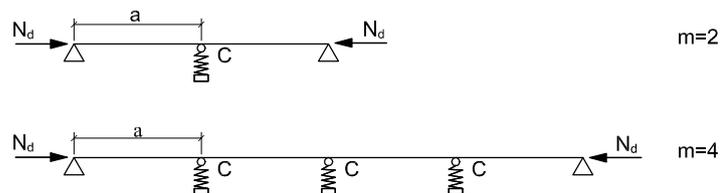
Figura 10.11 Piezas simples con restricciones laterales intermedias.
