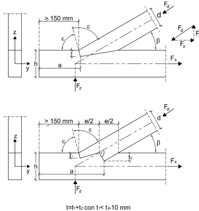
**Figura 8.15 Embarbillado simple y doble.**
