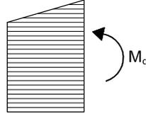
Figura 6.11 Tensiones de compresión en el borde inclinado (la zona rayada representa la dirección de laminado).
