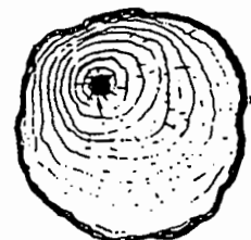
FIG. 9.8.—Excentricidad del corazón.
