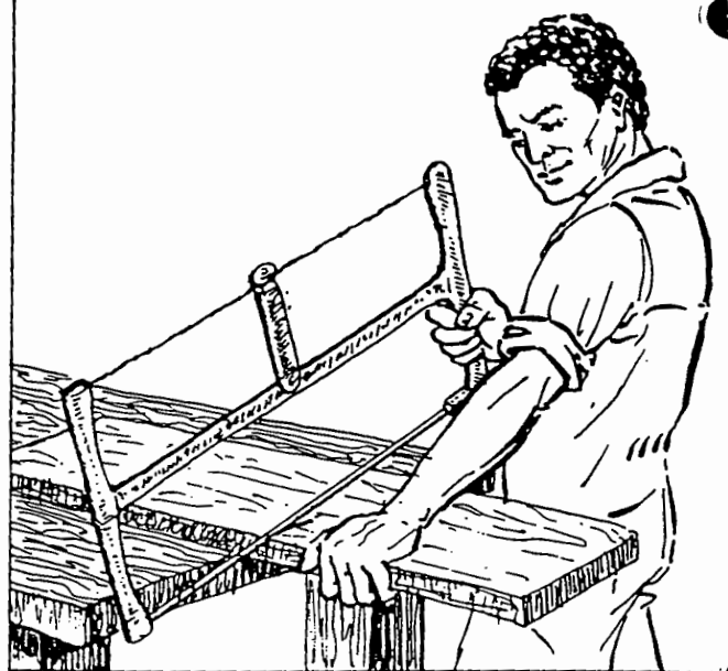
FIG. 11.9.—Aserrado al hilo.
